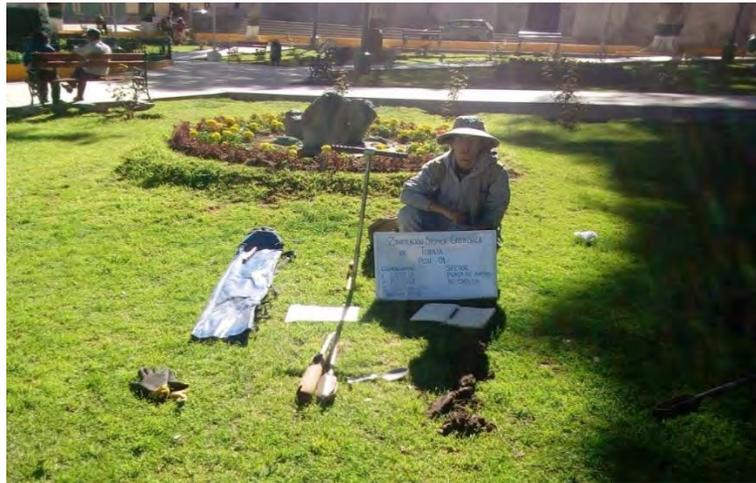
Nota. El tipo de suelo identificado mediante el ensayo de posteo hasta los 0.50 m de profundidad, se encuentra representado por suelos arcillosos con gravas, >1mm, de diámetro de color marrón oscuro, principalmente.
