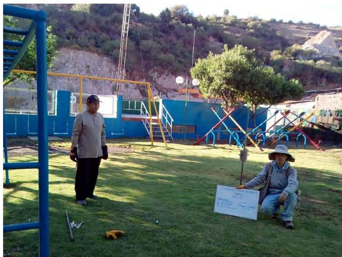
Los ensayos de DPL han alcanzado una profundidad máxima de 3.50 m (DPL-4) y mínima de 0.45 m, ya que los suelos están conformados por gravas que presentan ángulos de fricción entre 38.5° y 40.5° en promedio, característico de suelos granulares de compacidad alta.
