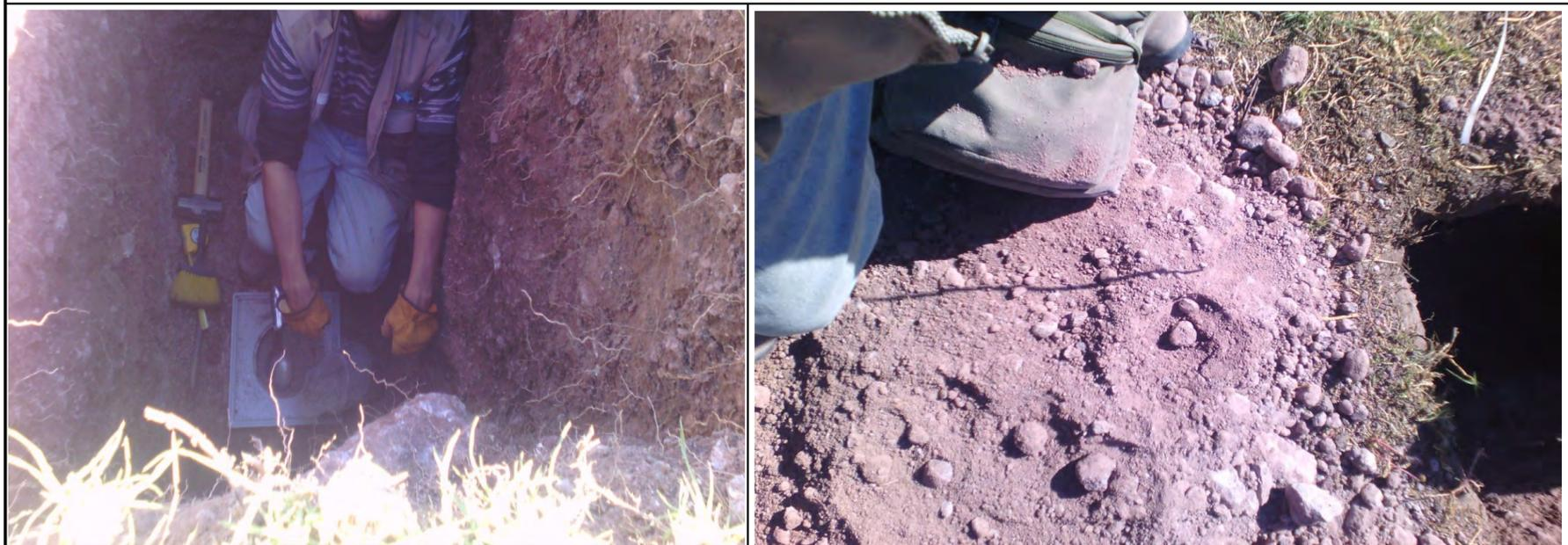
Ensayo de densidad in-situ, en la calicata 04 .
