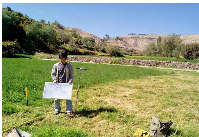
El tipo de suelo reconocido mediante el ensayo de posteo hasta los 1.00m. de profundidad se encuentra representado por arcillas inorganicas con gravillas .
