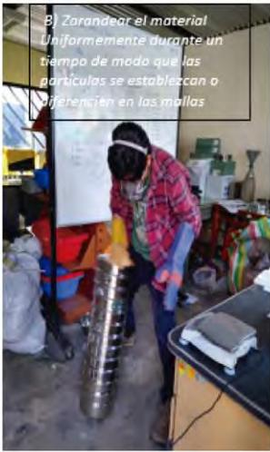
B) Zorandear el material Uniformemente durante un tiempo de modo que las partículas se establezcan o difieren en las mallas
