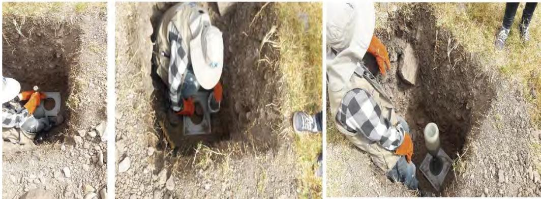
**Nota.** En las fotografías se observa la realización del ensayo del cono de arena, en la calicata - N° 1 en el Sector la Banda fuente: elaboración propia.
