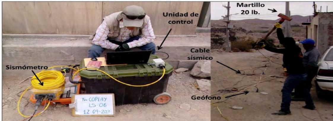
*Nota.* Adquisición de datos y los componentes para el registro de arreglos lineales MASW. Fuente, (IGP) -2018.
