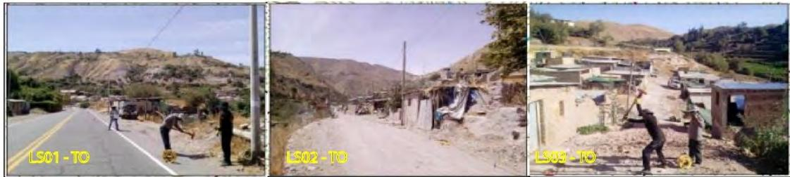
**Nota.** En la figura 60, se observa las Líneas sísmicas (LS01 -TO), Líneas sísmicas (LS02 -TO), Líneas sísmicas (LS03 -TO), realizadas en la localidad de Torata. fuente: Instituto geofísico del Perú -2018. En los sectores, La Banda, Jorge Chavez “B”, y Calle – Torata.
