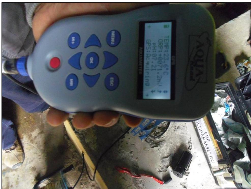
Multiparámetro portátil Aqua Meters AQUAREAD, utilizado para medir los parámetros físico – químicos de campo ( T°, pH, Conductividad Eléctrica y Total de Solidos Disueltos) de calidad de agua subterránea
