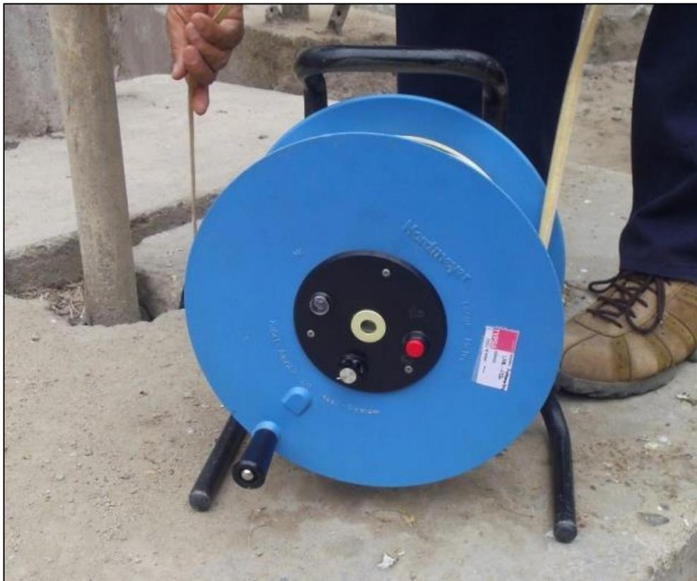
Las mediciones del nivel estático se obtuvieron introduciendo la sonda por un costado del pozo, ya que no se contaba con un pozo de observación cercano ni un piezómetro, cuando el electrodo entraba en contacto con el agua, esta emitía un sonido marcando de esta manera la lectura que correspondía, anotando el valor en un tabla, este procedimiento continuó hasta llegar al nivel estático, y se repite el procedimiento de la toma de datos con la sonda acústica para la etapa de recuperación.
