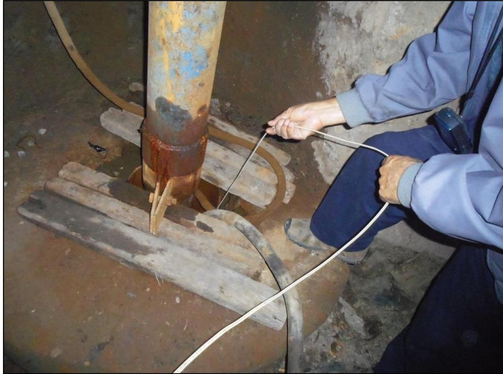
El operador de agua realiza la prueba de bombeo, midiendo el descenso del nivel del agua con ayuda de la sonda acústica, estos valores son anotados en el formato utilizado para las pruebas de bombeo
