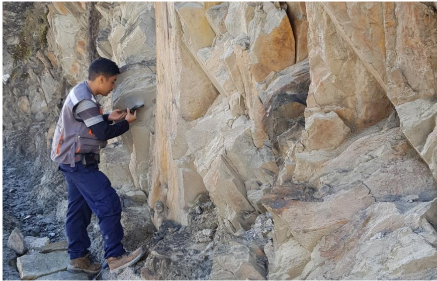
Fotografía 3.4 Toma de datos de rumbo y buzamiento con brújula tipo Brunton en la zona de estudio.
