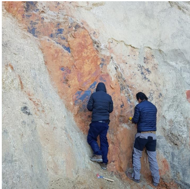
Fotografía 3.5 Tomando datos estructurales en un plano de falla de tipo normal dextral de dirección N 200° que afecta la Súper Unidad Coasa, al SE de la zona de estudio.
