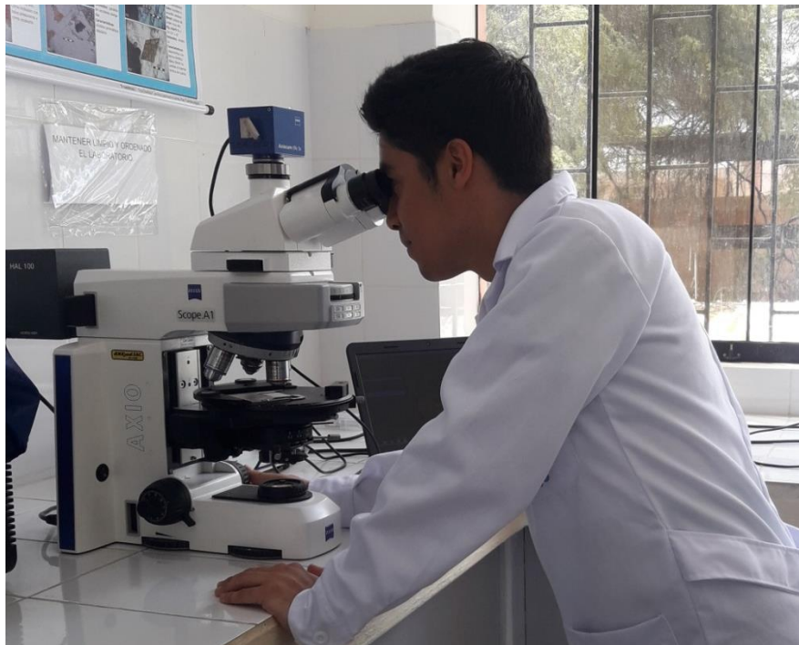
Fotografía 3.3 Estudio de las secciones delgadas de roca en microscopio petrográfico.
