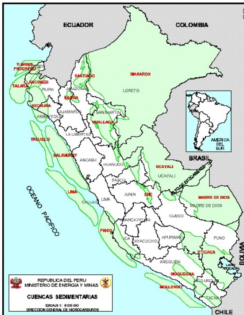
Fig. 2.8: Principales Cuencas petrolíferas del Perú. En el flanco occidental del Perú se observa las Cuencas de tipo Antearco, como las Cuencas Tumbes, Lancones, Talara, Sechura, Salaverry, Trujillo, Lima, Pisco, y Mollendo.
