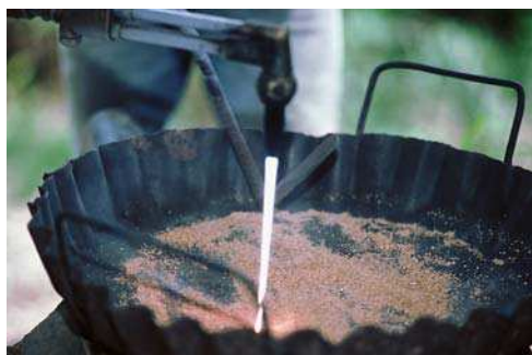
Brûlage à l'air libre de l'amalgame Au-Hg le long du Rio K'aka (Bolivie, 1999) - Photo L. Maurice ©IRD
