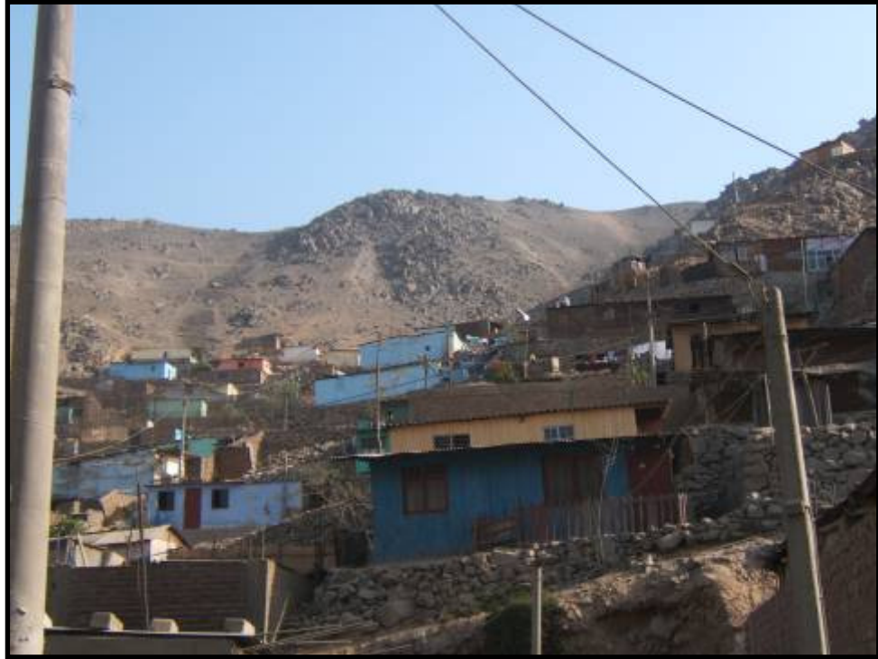
Foto N° 7. 13 AAHH Saúl Cantoral. Caída de Rocas con una zona de arranque irregular compuesta por bloques aislados subangulosos, dispuestos en una ladera con una pendiente de 40°
