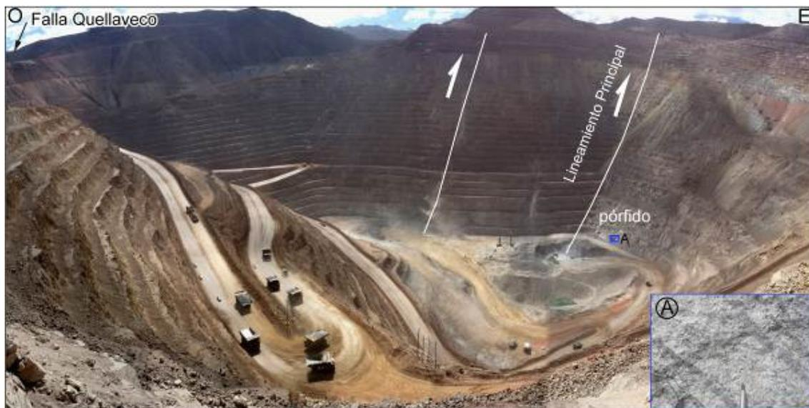
Foto 28. Vista panorámica del pórvido de Cuajone, donde se muestra la ubicación de la falla Quellaveco y el lineamiento Principal. A) Foto de la alteración potásica con vetillas del tipo A.
