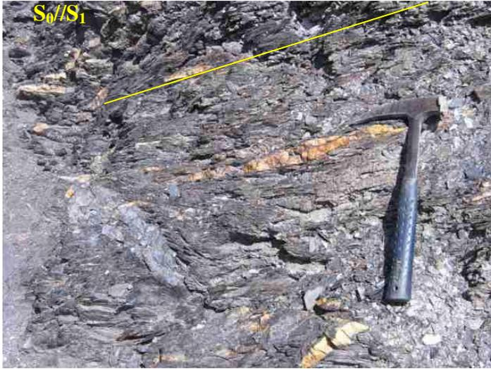
Foto. 4.13. Foto tomada en la margen derecha del Río Chuzgón de la unidad de filitas negras, se puede apreciar los abundantes lentes de cuarzo segregado de espesor de 5cm entre los planos de foliación, orientados en forma paralela a los planos de foliación, definidos como  $S_0 // S_1$  con una orientación  $N60^\circ O$  y ángulo de inclinación  $40^\circ SO$
