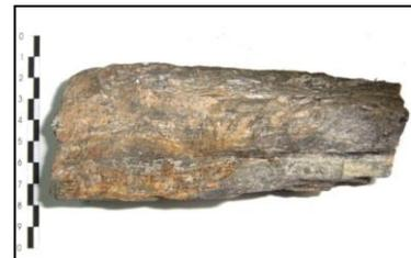
Foto.4.10 .En esta muestra de mano se puede observar la estructura bandeada, con textura fanerítica.
