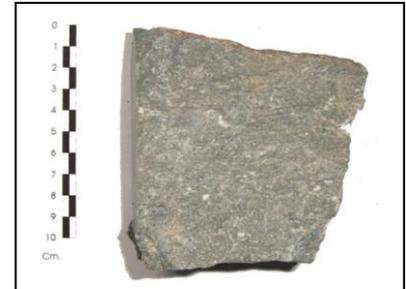
Foto 4.26. En esta foto se puede apreciar que la roca posee una estructura bandeada irregular compuesta de blastos subredondeados de plagioclasa, clorita y cuarzo, que define la foliación de la roca con una matriz afanítica.
