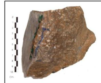
Foto 4.18. En esta muestra se puede apreciar con más detalle los blastos de cuarzo englobados en una matriz fina.
