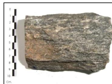
Foto 4.2. Foto de la muestra de mano. Se puede apreciar la estructura bandeada de la roca. Está compuesta por minerales de cuarzo, clorita y feldespato K.
