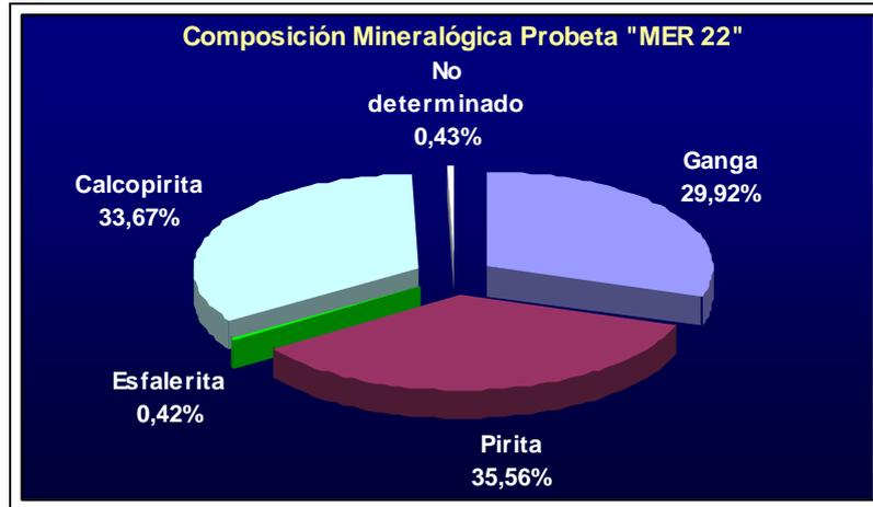
Figura 108. Composición mineralógica del todo uno por ADI (Probeta MER 22).
