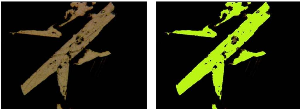
**Figura 58.** Estibina segmentada utilizando rangos de segmentación con ajusta 95 %.
