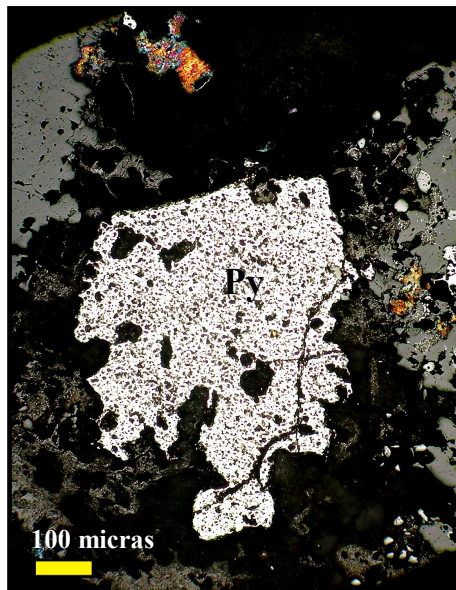
D) Gal-141007-001A : Pirita con textura oquerosa y forma anhedral, sin relleno de ningún otro mineral, poco fracturada. Las oquedades se presentan en dos tamaños diferentes.
