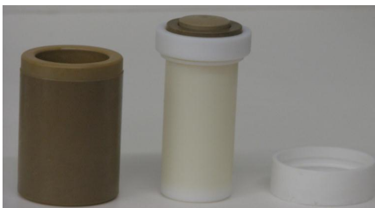
Figura 4.8. Esquema de los componentes de un contenedor de reacción de PTFE para microondas analítico
