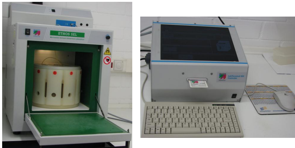
Figura 4.7. Horno microondas Milestone con su respectivo controlador de temperatura y presión
