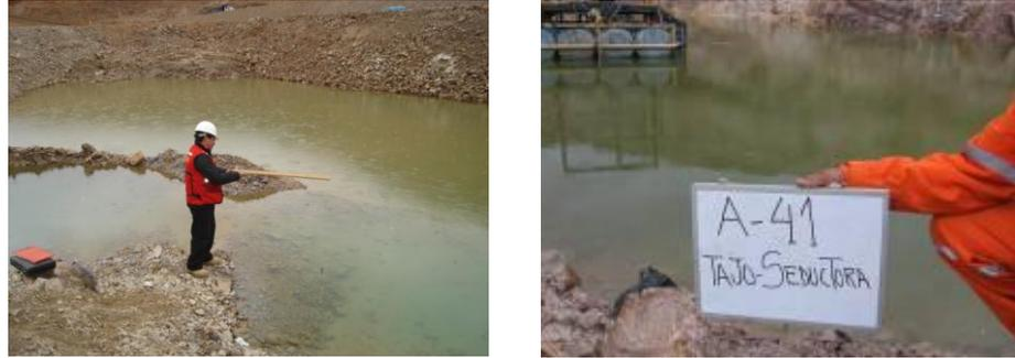
**Fotografías N° 5.6 y 5.7** A la izquierda nivel freático en el tajo Sacalla. A la derecha nivel freático en el tajo Seductora.
