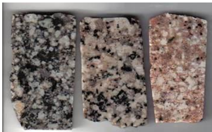
Foto 3.11 Láminas delgadas de las muestras BT- 144, BT -145 y BT – 151 camino Callangate – Qda. Tubaybal, se nota gradación en el contenido de minerales oscuros.
