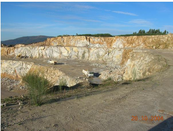
**Foto 4.2** En la figura se ven los 3 bancos principales de explotación.
