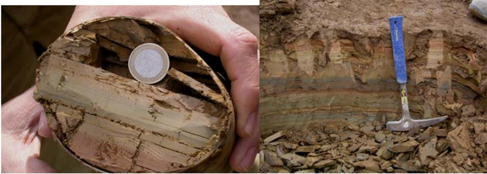
Figura 5.5. El espesor de las capas o estratos en el interior de la cancha de relaves y la variedad de colores que muestran los distintos grados de oxidación de la muestra en superficie.
