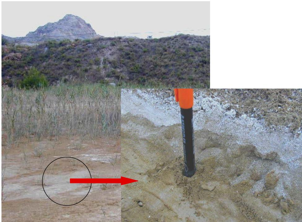
**Figura 4.5.** Costra de sales de sulfato que se forma en la zona endorreica del depósito Brunita debido a la evaporación y al ascenso capilar del agua. El espesor de la capa de sales es variable entre 3 y 6 cm. Se puede observar que en esas condiciones de elevada salinidad se desarrolla la vida vegetal donde crece *Phragmites australis*.
