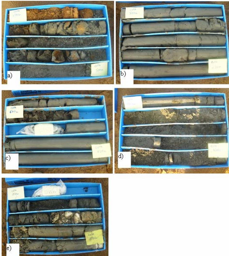
Figura 5.4. Sondeo en la cancha de relaves Brunita. A) 0-3 m, b) 3-6 m, c) 6-9m, d) 9-12 m, 12-15 m.
