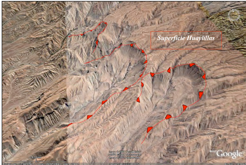
Fig. 2.5: Superficie Huaylillas mostrando los escarpes de deslizamientos, ubicados al noreste de la localidad de Pachía. Imagen Google Earth
