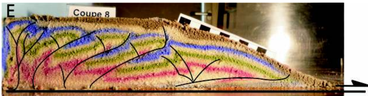
Fig. 24: Sección al nivel de la zona de transición del Modelo 3. En la parte inferior un nivel de color anaranjado que representa la ubicación de la zona de fricción.
