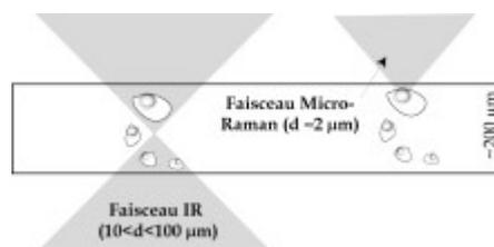
**Figure VI.1 :** Comparaison des faisceaux IR et micro-Raman. Le faisceau Raman permet des analyses d'inclusion en haute résolution sous la surface de la lame. Le faisceau IR moyenne l'information sur une surface de  $\sim 100 \times 100 \mu\text{m}$ , incluant une mesure de la quantité d'eau sur toute l'épaisseur de la lame entre deux angles coniques.
