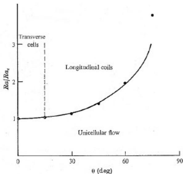
Figure A5.1 : Géométrie des cellules de convection en fonction du rapport  $Ra/Ra_{\text{critique}}$  et de l'inclinaison de l'horizon perméable, d'après Bories & Combarous (1973). Trait noir : relation théorique. Points noirs : données expérimentales.
