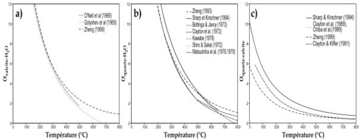
**Figure IV.1 :** Calibration des équations de fractionnement en fonction de la température. a) Couple calcite-H<sub>2</sub>O. b) Couple quartz-H<sub>2</sub>O. c) Couple quartz-calcite.
