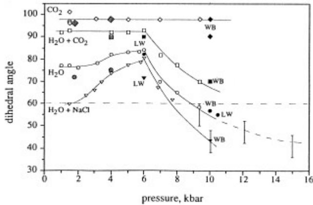
**Figure VI.5 :** Variation de l'angle diédral quartz-fluide avec la pression à 800 °C, d'après (Holness, 1992). Cercles = quartz-H<sub>2</sub>O ; carrés = quartz-CO<sub>2</sub>-H<sub>2</sub>O ; losanges = quartz-CO<sub>2</sub> ; triangles = quartz-NaCl ; symboles noirs : données issues d'autres publications (WB : Watson & Brenan, 1987 ; LW : Laporte & Watson, 1991). Symboles grisés : données à 1000 °C. erreur  $\pm 5^\circ$  sur les mesures d'angle diédral.
