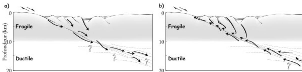
**Figure 1** : Modèles hydrologiques de circulation des fluides au travers d'un détachement crustal. a) circulation descendante; les fluides franchissent la transition fragile-ductile. b) Circulation ascendante. Les fluides superficiels sont arrêtés par la transition rhéologique, et les circulations profondes ont une origine interne.
