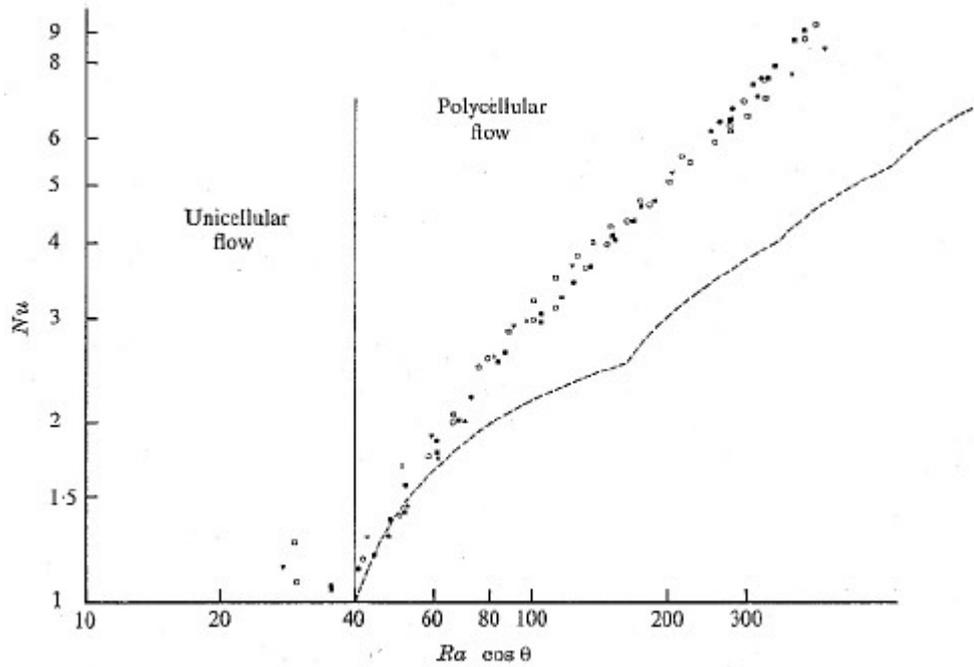
Figure A5.2 : Transferts de chaleur moyens en fonction de l'inclinaison de l'horizon perméable. Tirets : Relation théorique. Données expérimentales : ●  $q = 7.5^\circ$  ; ▲  $q = 15^\circ$  ; ■  $q = 22.5^\circ$  ; ○  $q = 30^\circ$  ; ▼  $q = 45^\circ$  ; □  $q = 60^\circ$ .
