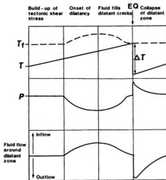
Figure I.17 : Diagramme synoptique du processus de pompage sismique (d'après Sibson et al., 1975).  $t$  : contrainte cisailante.  $P$  : pression de fluide.  $t_f$  : résistance au cisaillement ( $t_f = \mu(S_n - P)$  où  $\mu$  est le coefficient de frottement et  $S_n$  la contrainte normale au plan de frottement). Le sens et la magnitude du flux sont représentés en bas du diagramme. EQ : earthquake.  $\Delta t$  : relâchement de la contrainte.
