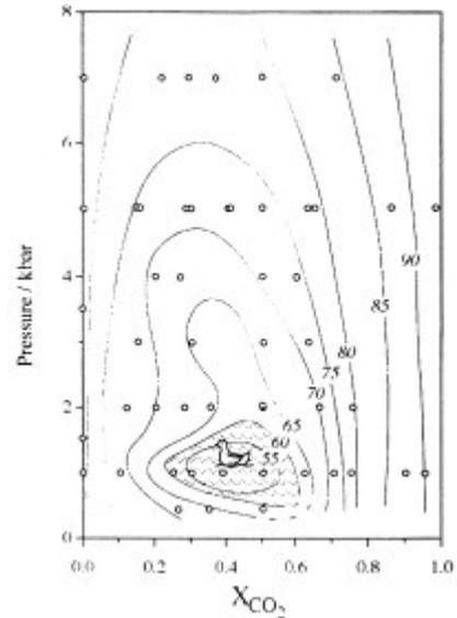
**Figure VI.6 :** Diagramme P-XCO<sub>2</sub>-q pour la calcite à 650 °C d'après (Holness & Graham, 1995). La zone grisée représente la fenêtre dans laquelle une roche composée de calcite est perméable (q < 60°).
