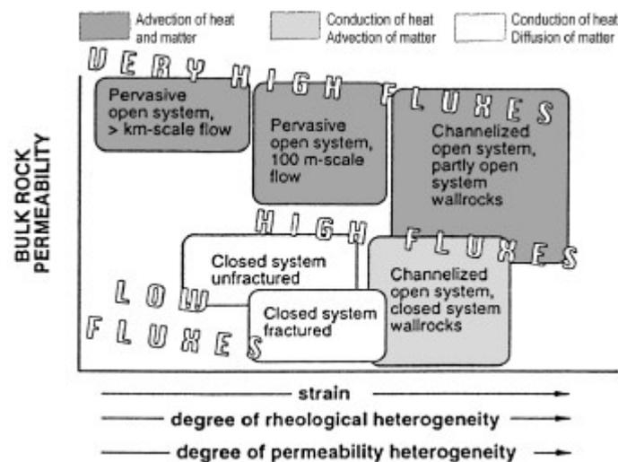
**Figure I.6 :** Classification des différents types de circulation de fluides en fonction de la perméabilité, de la déformation et des flux. Les transports de chaleur et de matières sont ajoutés pour chaque type de flux (modifié d'après Oliver, 1996).
