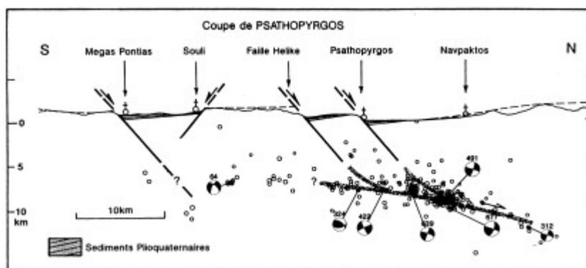
**Figure II.5 :** Micro-sismicité dans le golfe de Corinthe entre Juillet et Août 1991, d'après Rigo (1994). Sur une coupe Nord-Sud, les microséismes sont répartis le long d'un plan à faible pendage vers le Nord, entre 10 et 12 km de profondeur. Les essaims sont dans le prolongement des grandes failles normales à fort pendage de la région.
