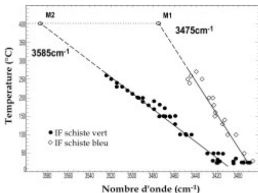
*Figure VII.5 : Position du pic des spectres d'inclusions fluides en fonction de la température. M1 : Inclusions du faciès schiste bleu. M2 : Inclusions du faciès schiste vert (tous types confondus).*
