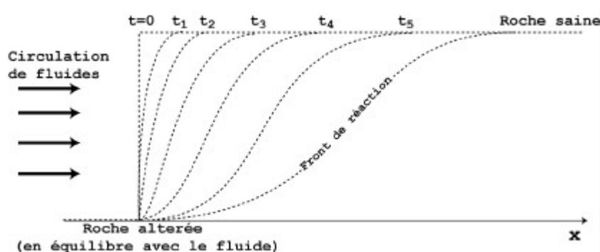
**Figure I.1 :** Schéma d'évolution chromatographique d'une réaction chimique ou isotopique entre le fluide en circulation et la roche encaissante. La forme du front de réaction est liée à la quantité de fluides ayant circulé.
