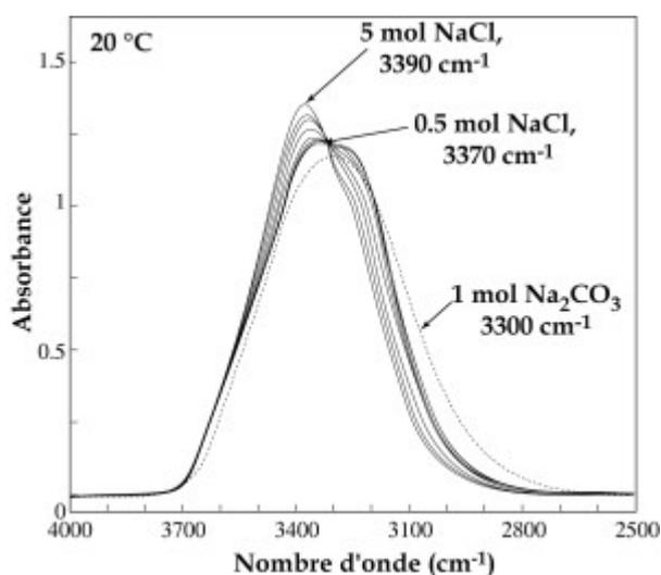
*Figure VI.4 : Variation de la position du spectre IR d'une solution aqueuse en fonction de la composition et de la concentration, à température constante (par une méthode ATR). Le pic apparent d'une solution à 0.5 mol NaCl est à  $3370\text{ cm}^{-1}$ . Le pic apparent d'une solution à 5 mol NaCl est à  $3390\text{ cm}^{-1}$ . Le pic apparent d'une solution à 1 mol  $\text{Na}_2\text{CO}_3$  est à  $3300\text{ cm}^{-1}$  (Masuda et al., in press).*
