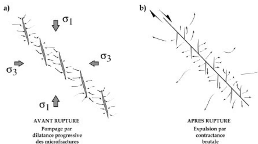
**Figure I.16 :** Mouvement de fluides par dilatance-contractance au cours des cycles sismiques. a) Avant fracturation lors de l'accumulation progressive des contraintes. b) Après rupture, lors du relâchement brutal des contraintes.
