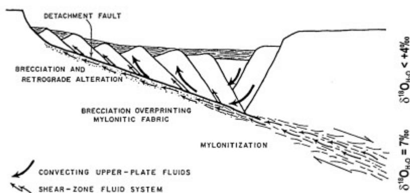
**Figure II.10 :** Coupe schématique d'un détachement montrant deux systèmes aquifères distincts, d'après Reynolds (1987). Le mur est traversé par des circulations de fluides magmatiques vers le haut, dont le moteur est le gradient de charge ou le pompage sismique. Le toit est infiltré par des fluides surfaciques, dont la circulation est activée par convection libre. Les valeurs du  $\delta^{18}\text{O}_{\text{H}_2\text{O}}$  sont celles de Kerrich (1988).
