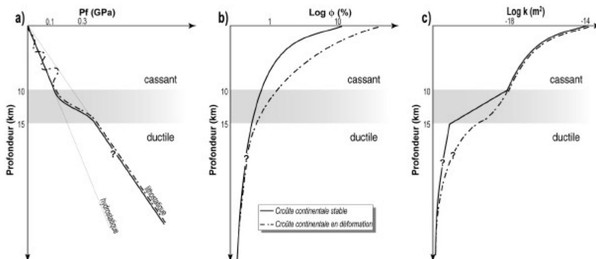
: a), b) et c) Profils synthétiques de pression des fluides ( $P_f$ ), de porosité ( $\phi$ ) et de perméabilité ( $k$ ), respectivement, de la croûte continentale en fonction de la profondeur. Traits pleins : croûte stable. Tirets : croûte déformée. Les points d'interrogation soulignent les zones où aucune donnée n'est disponible. Voir texte pour justification.
