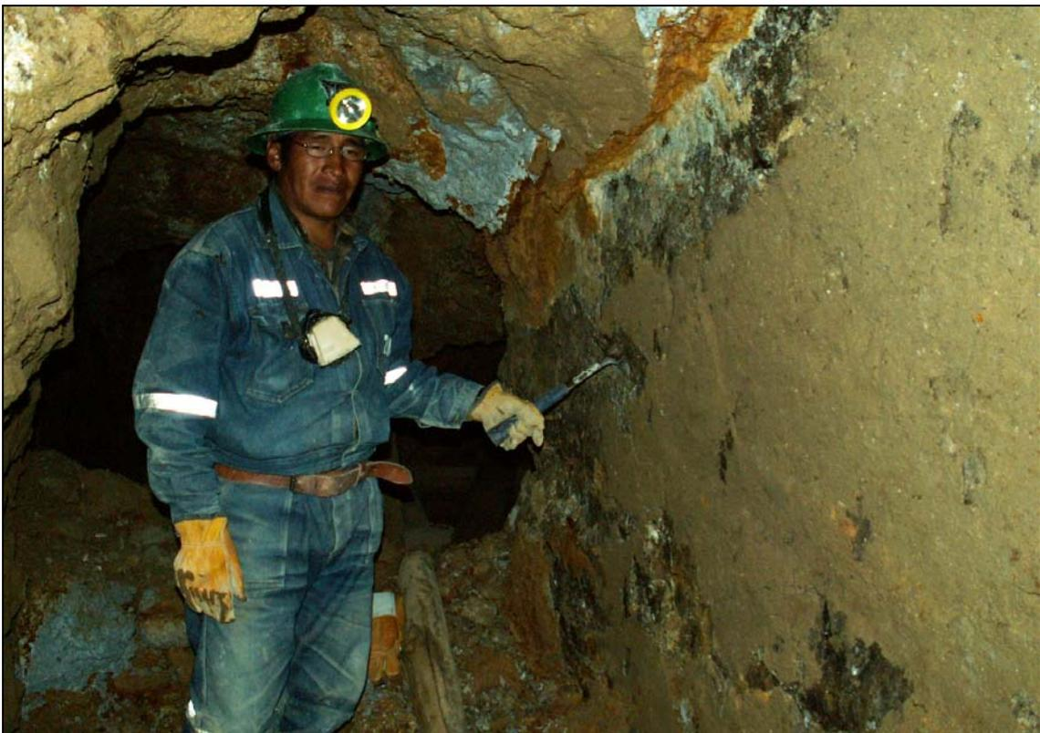
**Foto 6.** Fallas inversa con alto ángulo desarrollada sobre plano de falla NNE con movimiento inicial dextral. SNv. 81SW del Nivel 4261.
