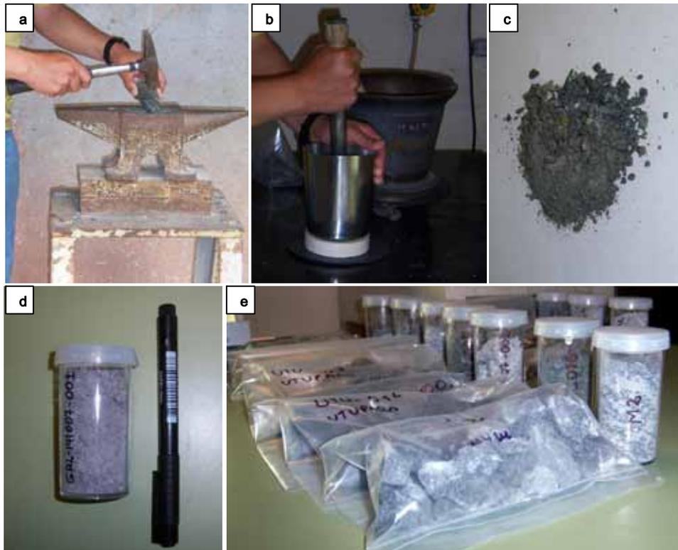
**Figura 5.31:** Chancado y pulverización de muestras. a) Reducción a esquirlas de 1cm; b) Reducción de esquirlas a fracción  $< 0.5$ cm.; c) Muestra a fracción  $< 0.5$  cm.; d) Muestra a fracción  $< 0.5$  cm. lista para ser pulverizada en molino de bolas; e) Muestras listas para ser tamizadas más contra-muestras en bolsas.
