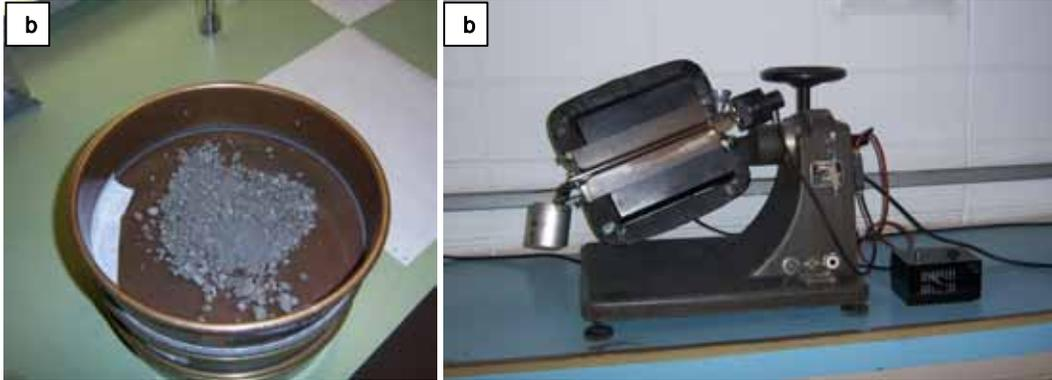
**Figura 5.33:** Tamices y separador magnético. a) Juego de tamices conteniendo muestra a fracción < 0.5 cm lista para ser tamizada; b) Separador magnético isodinámico Frantz.
