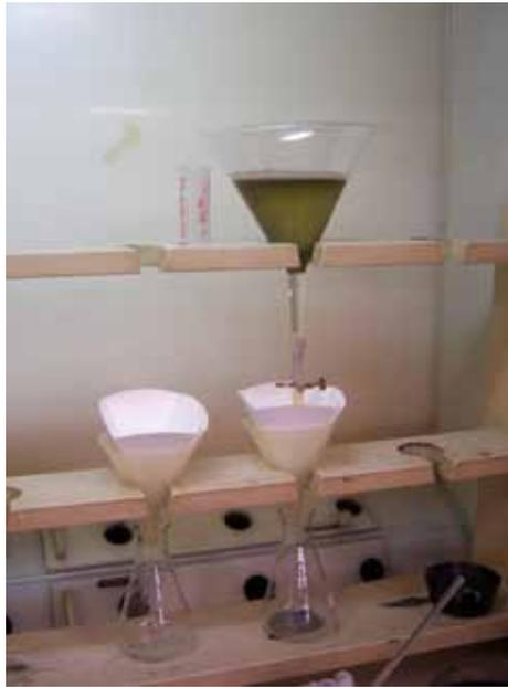
**Figura 5.34:** Equipo para separación por líquidos densos. La muestra es vertida en el embudo que contiene yodatos reciclados, la separación es por peso específico.
