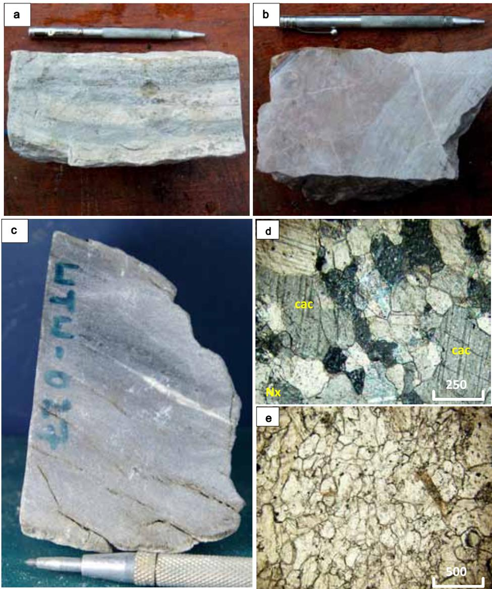
**Figura 5.12:** Muestra de mano y fotomicrografía de mármol. a) Muestra de mármol blanco bandeado; b) mármol rosado con venillas de calcita; c) mármol gris, bandeado con venillas de calcita; d) fotomicrografía en nicols cruzados de mármol gris, se distingue textura granoblástica evidenciando recristalización de la calcita; e) fotomicrografía de mármol en nicols paralelos
