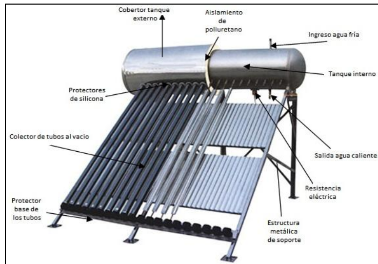
Figura - 10 Componentes del calentador solar de tubos al vacío.
