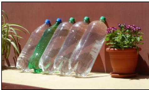
Figura - 3 Envases de gaseosas hechos de PET y lavador conteniendo agua expuestos al Sol.
