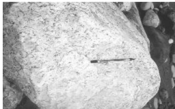
Figura N° 3. Quebrada Catsingari Sur: Estación 53-54. Bloque de granito rosado gneisico, con granos de ortosa y cuarzo de textura augeneisica, rodeado de biotita.
