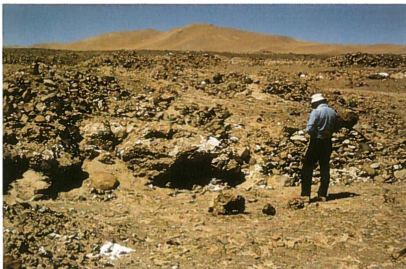
FIG. texto 4. Frente de explotación en la zona de Pedro de Valdivia. Se muestra la vista panorámica de un yacimiento sedimentario aluvial con cantos rodados cementados por material salino.
