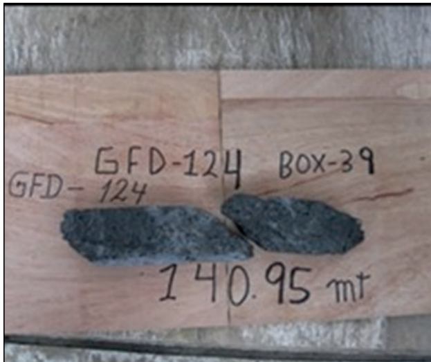
Figura N°3. Estructura de alteración epitermal en testigos o sondajes diamantinos, en el contexto del pórfido Corona.
