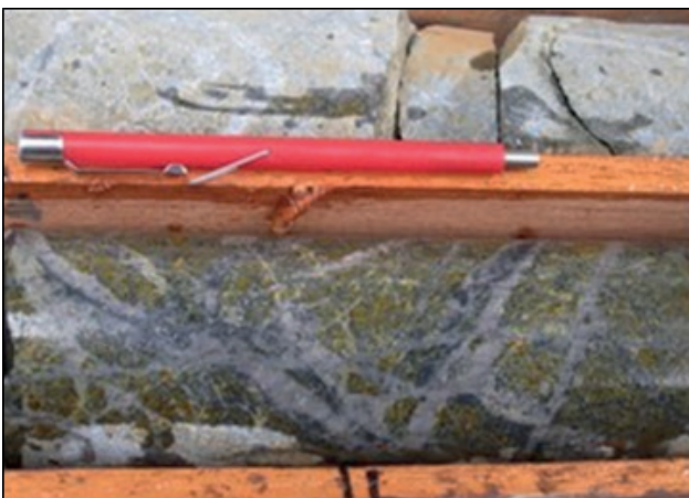
Figura N°4. Testigo o Core de perforación diamantina, en que se muestran las alteraciones propias de un pórfido con estructuras de sílice de sobreimpresión teñidas de jarosita de tonos pardos a amarillos.
