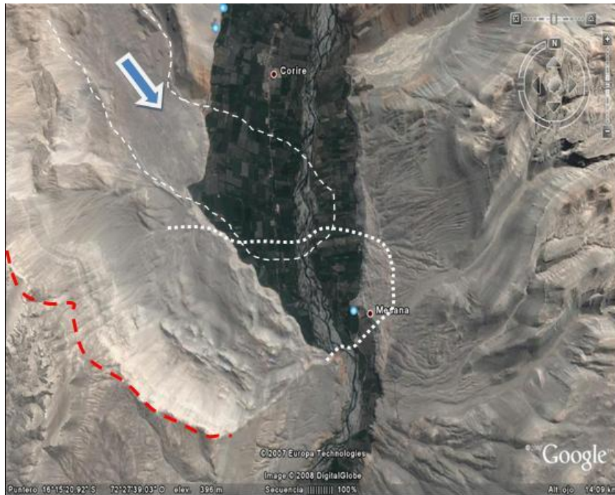
Figura Nº 4 Vista panorámica del deslizamiento “Punta Colorada”, donde se observa la dirección del deslizamiento N 60° E y luego es afectado por un flujo de lodo de menor tamaño.
