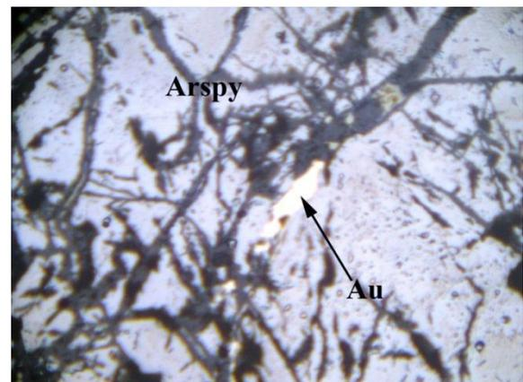
Figura 7: Oro como relleno de microfracturas en arsenopirita. Este tipo de oro para su tratamiento metalúrgico es considerado como dócil, de una fácil liberación en la molienda. Luz reflejada 200 X
