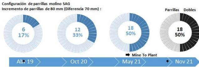
Figura 17 – Incremento de parrillas de 80 mm
