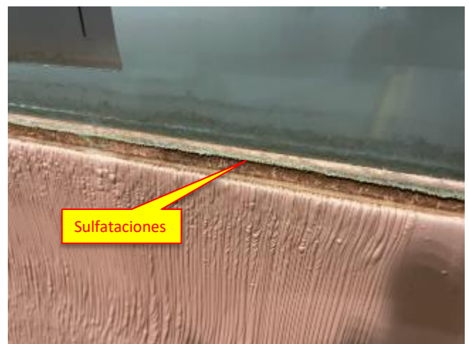
Fig. 12. Cátodo con sulfataciones en el borde superior
