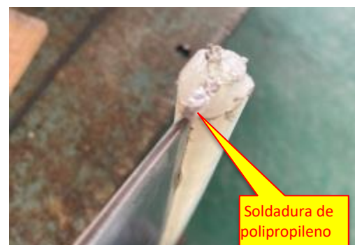
Fig. 15. Relleno de soldadura de polipropileno, utilizado para sellar los cubrecantos
