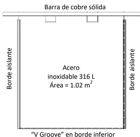
Fig. 4 Diseño mejorado de cátodo permanente.
