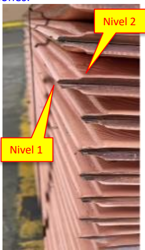
Fig. 13. Vista de los bordes superiores de los cátodos libre de sulfataciones.
