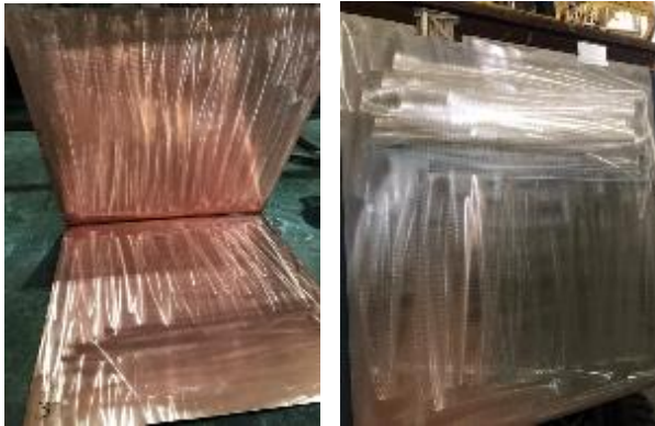
Fig. 10. Cátodo buena adherencia. Producido a partir de una plancha pulida con abrasivo N°40.
