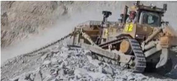
*Nota.* Sistema de cadeneo utilizado en trabajos especiales de perfilado y estabilización en SMCV. Elaboración propia.
