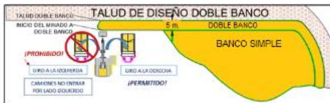
Nota. Trabajo de minado en banco doble en Sociedad Minera Cerro Verde. Tomado de SCpr0305 Perfilado y Estabilización de Taludes V13 (p.26), por Sociedad Minera Cerro Verde, 2021.
