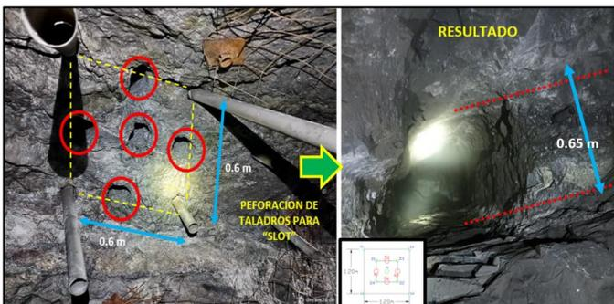
**Fig.18** Generación de Slots para Cara libre en SLS. Véase la perforación a 0.6 mts y ejecutado 0.65 mts.
