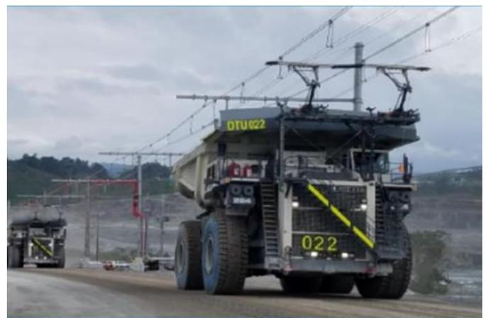
Figura 8 – Operación minera y el uso de sistema Trolley
