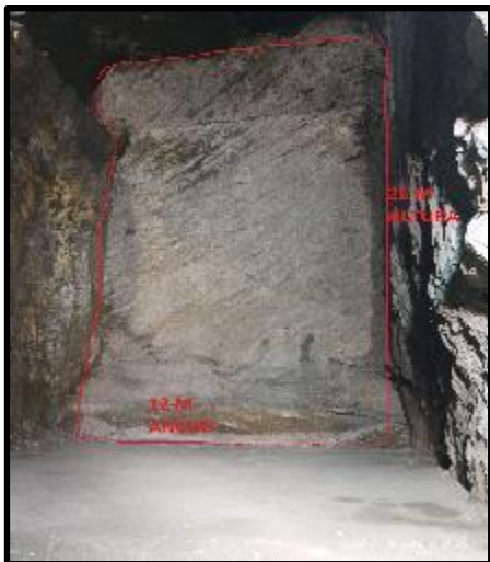
Fig.28. Pared de relleno expuesto, 300 m 2
