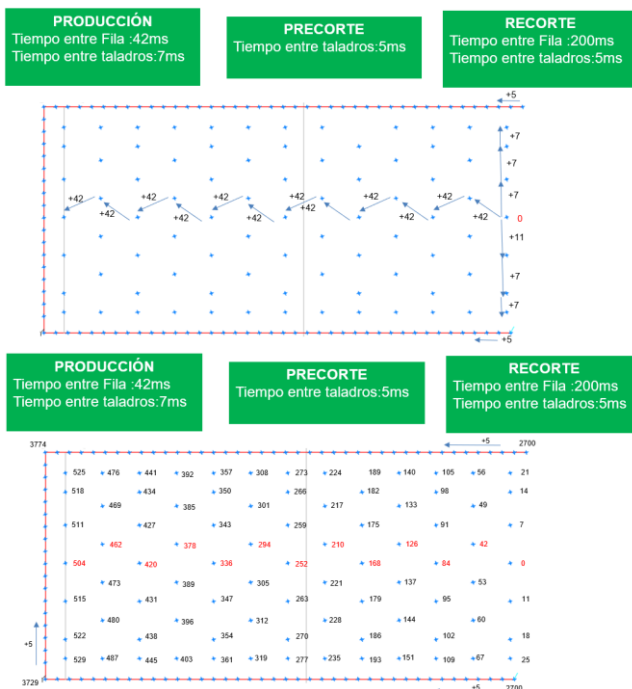
Fig.16. Secuencia de carguío de taladros
