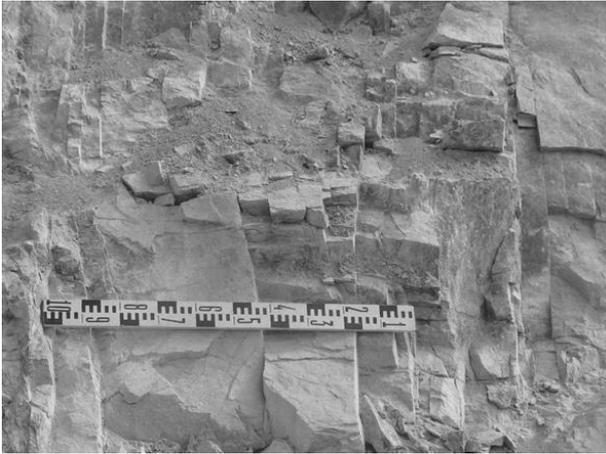
Figura 3. Utilización de una regla de longitud conocida para medir la frecuencia o el espaciamiento aparente de una familia de discontinuidades (Maldonado, 2007).
