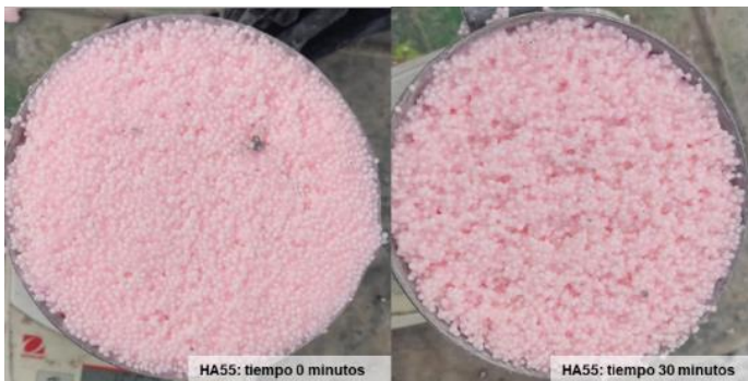
Figura N°5: Gasificación inicial y final de HA55 Fuente: Orica
