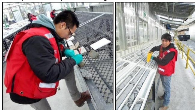
Figura 4: Método de obtención del Ti y el Zr con el equipo portátil de XRF, se dibujaron 4 círculos del radio del foco del XRF (2cm), de las 4 lecturas se utilizó el promedio y se observó que las rocas logueadas como Endoskarn, eran Exoskarn por su contenido de Ti y Zr.
