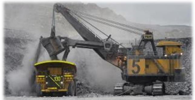
Imagen 4: Carguío de Camión KOM 930E por Pala P&H 4100
