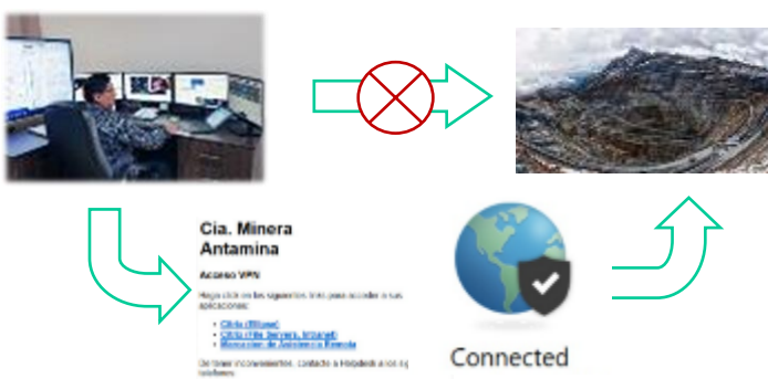
Imagen 14: Método de Funcionamiento de la Red VPN, El despachador utiliza la Red VPN para ingresar a los servidores de Antamina
