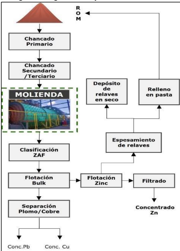
Figura 2: Diagrama de flujo de la UM Cerro Lindo
