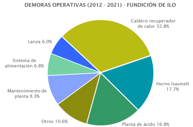
Figura 10: Causas principales de no operación del horno Isasmelt (2012-2021) de la Fundición de Ilo
