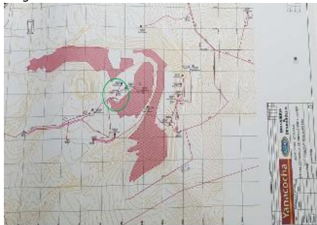
Figura 12: Plan de ubicación del sistema de energía eléctrica en el Tajo La Quinua del mes de setiembre 2006. Dentro del círculo verde se ve el transformador eléctrico (figura 7) ya reubicado fuera de la zona de minado. Como este trabajo se planifico con anticipación, se logró minimizar la parada de los pozos y se logró ahorros en el presupuesto al optimizar las sinergias.
