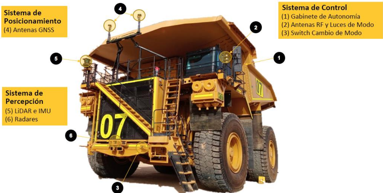
Figura 1: Componentes del sistema del camión autónomo Cat
