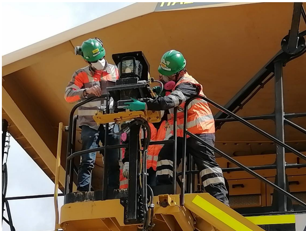
Figura 2: Calibración de la percepción- Ajuste del LiDAR
