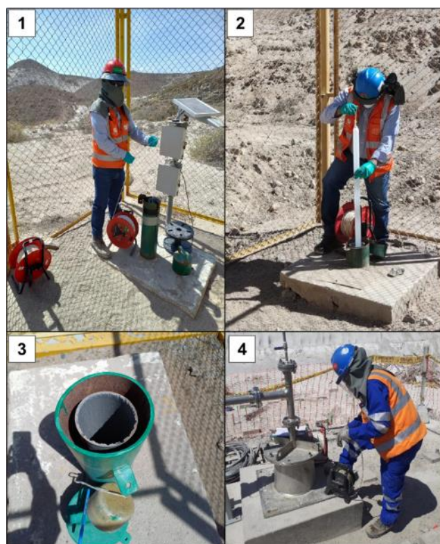
Fig. 06: Trabajos de campo de personal técnico del equipo de hidrogeología Cerro Verde. (1) Medición adicional de nivel de agua en un piezómetro automatizado con el objetivo de calibrar los sensores y controlar la calidad de los datos. (2) Extracción de muestra de agua desde un piezómetro haciendo uso de bailer, con el fin de realizar ensayos en laboratorio acreditado para calidad de agua. (3) Detalle de piezómetro tipo Casagrande para toma de muestras. (4) Medición de control en pozo de retrobombeo (SMCV, 2022).
