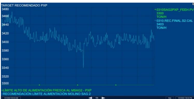
Imagen 9: aspecto de cálculo de máximo tonelaje posible realizado por el Maximizer en tiempo real, con
