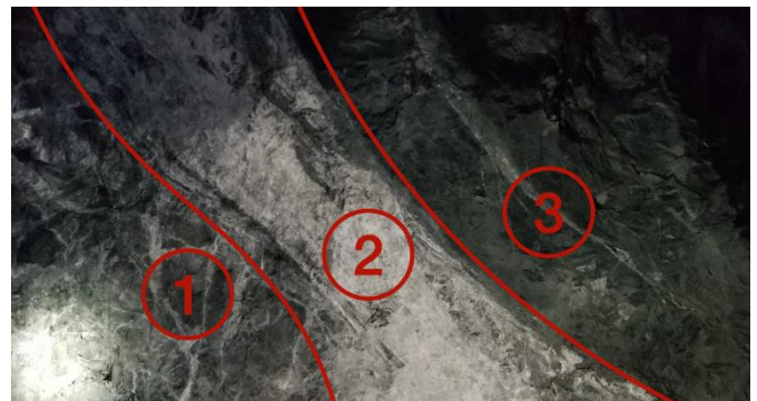
Figura 1. Sección de una de las vetas principales de la mina seleccionada. En esta figura se muestran los siguientes tipos de roca: (1) brecha, (2) veta de cuarzo y (3) roca caja.
