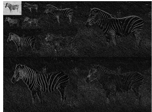
Figura 7. Descomposición por wavelets en tres niveles para una imagen de ejemplo usando el wavelet Haar de dos coeficientes.
