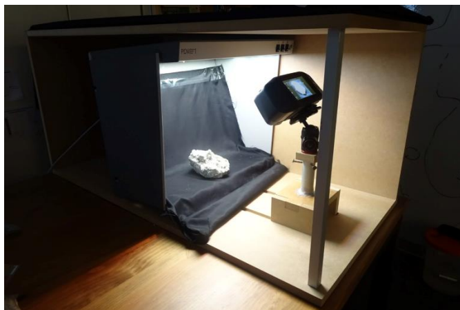
Figura 3. Hardware usado para capturar las imágenes del sistema de visión computacional. En la figura se muestra la estructura de MDF, usada para posicionar la cámara a una distancia y ángulo fijo; la caja de luz, usada para iluminar las rocas de manera uniforme y la cámara hiperespectral, la cual fue intercambiada por una cámara a color de acuerdo con el tipo de imagen que se necesitaba adquirir.
