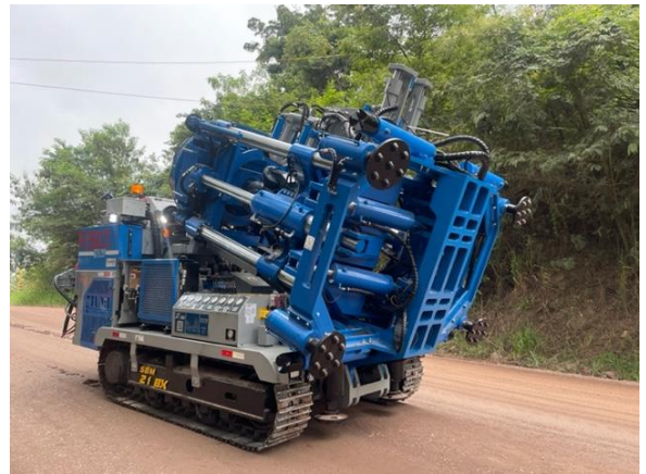
Fig. 29. Máquina Box Hole en camino a interior mina.
