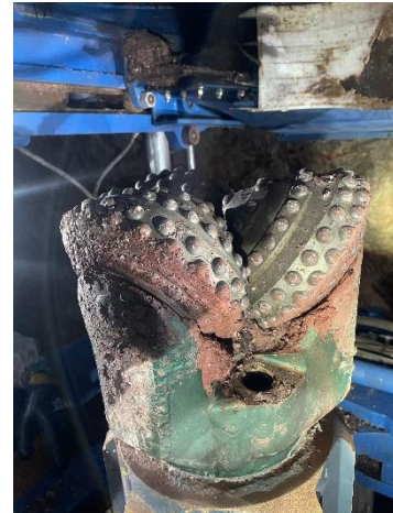
Fig. 26. Estado de los cortadores del tricono luego del primer proyecto.
