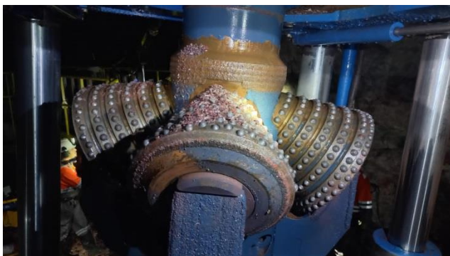
Fig. 25. Estado de los cortadores del Hole Opener luego del primer proyecto.
