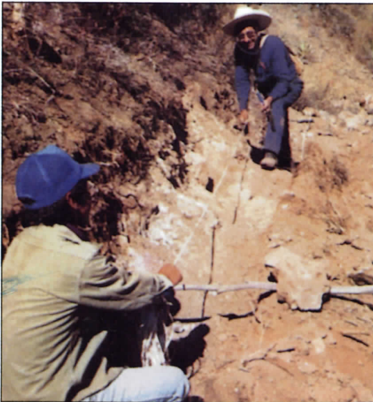
Construcción de trincheras en el prospecto Colpar (Arequipa)
