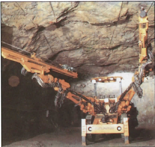
Jumbo para realizar operaciones de perforación en minería subterránea
