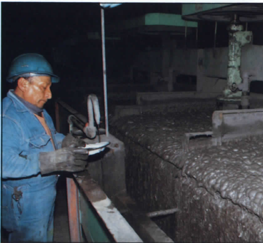
Circuito de flotación de plomo en la Cia. Minera Milpo - Cerro de Pasco
