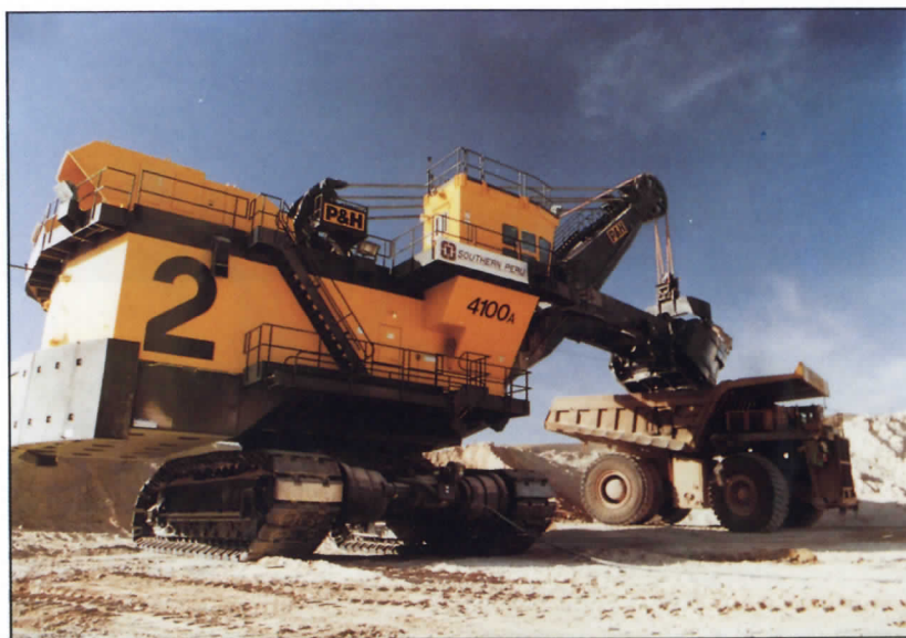
Pala de 80 ton cargando un volquete de 240 ton en la mina Cuajone Southern Peru Limited
