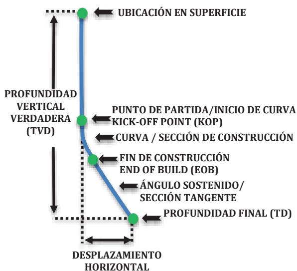
Figura 1: Parámetros clave en la perforación direccionada.
