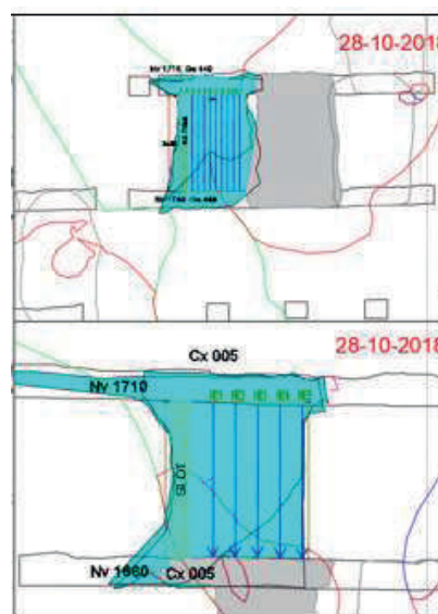
Figura 2: Ejemplo del levantamiento topográfico de un tajo vacío en la Unidad de Cerro Lindo Fuente: Área de Servicios Técnicos Cerro Lindo.
