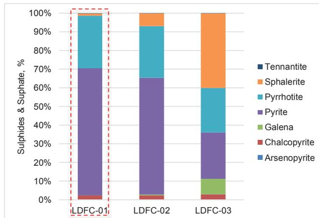
Figura N°10: Mineralogía del compuesto LDFC-01
