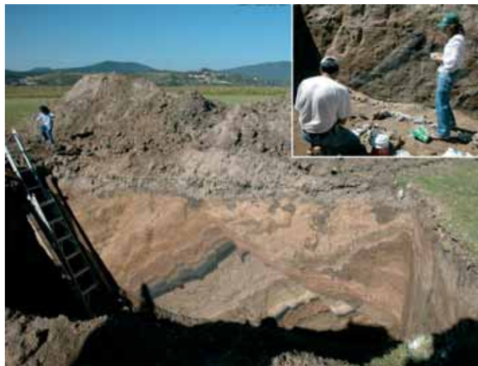
Figura 1. Trincheras realizadas en sedimentos lacustres holocenos del lago de Pátzcuaro, para localizar fallas activas y calcular la magnitud y edad de los terremotos acaecidos antes de las primeras crónicas históricas (isla lacustre de Jarácuaro, Michoacán, México).
