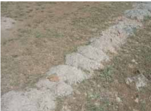
Figura 3. Muestras cada dos metros de un sondeo perforado mediante rotopercusión con martillo en fondo (foto: M. Martínez).
