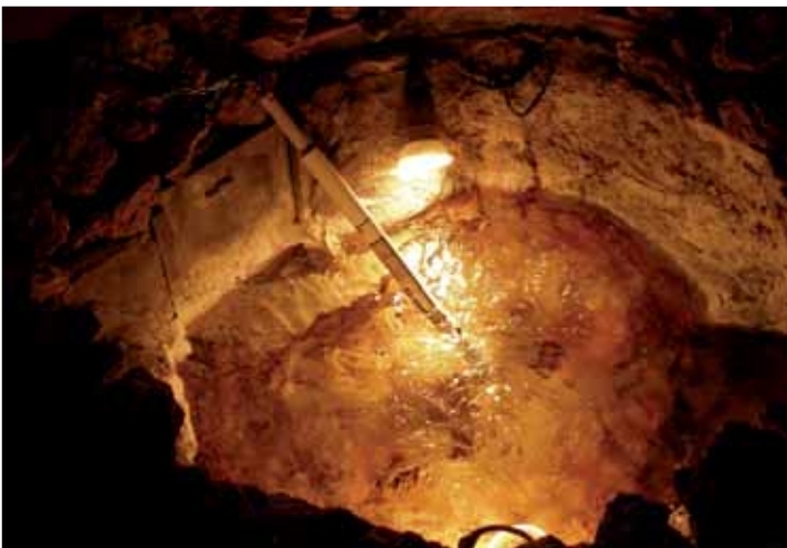
Figura 12. Equipamiento de surgencia para determinar de manera continuada la conductividad (foto: M. Martínez).
