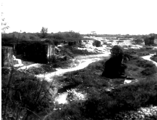
Foto 1 - Zona de extracción antigua en el sector j-4 (flanco sur). obsérvese en primer plano la acumulación de agua en el piso de la cantera y al fondo como quedó el frente de extracción
